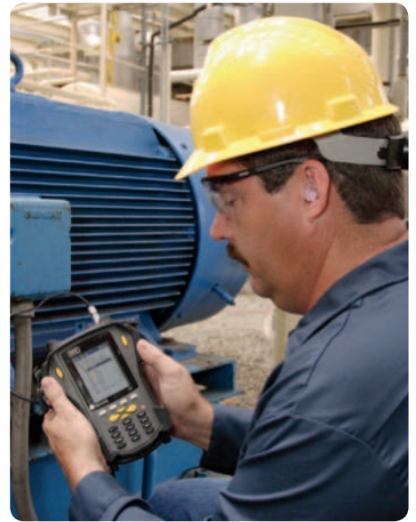
Registrazione dei valori di vibrazione mediante un dispositivo di acquisizione dati della serie Microlog della SKF
