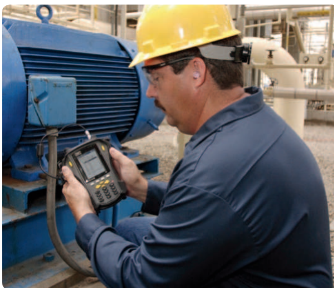
Dispositivi di acquisizione/analisi dei dati della serie Microlog della SKF
