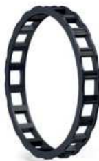
Le gabbie in PEEK consentono velocità più elevate e funzionamento più silenzioso
